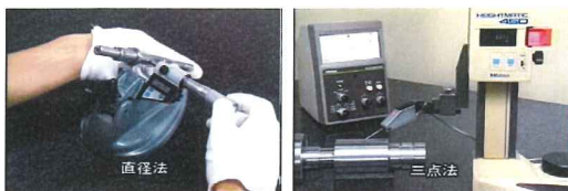
マイクロメータなどによる直径法 ダイヤルゲージや電気マイクロメータとVブロックなどによる三点法
