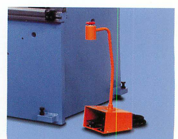
■ 非常停止上昇押し戻付フートスイッチ Emergency stop & return button on foot switch
