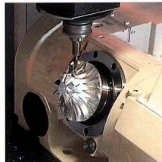
付加2軸傾斜インデックステーブルを使用した3次元輪郭加工 ワーク:インペラ加工 材質:アルミニウム合金
