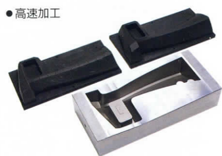
加工物：ブラケットカバー 加工物材質：S55C キャピティサイズ：640×290×130mm 電極材質：グラファイト
