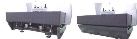
除振台 (左) と除振台を覆うアンダーカバー (右)
