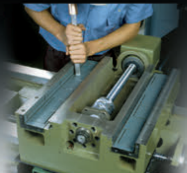
ミクロの精度を裏づける入念なキサゲ作業
