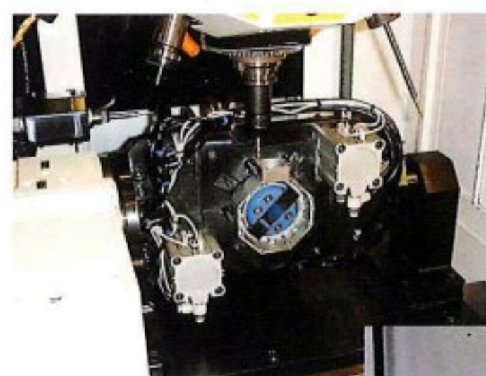
付加1軸インデックステーブルを使用した4面加工 ワーク: モータカバー 材質: ADC12
