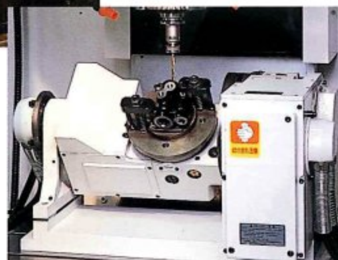
付加2軸傾斜インデックス テーブルを使用した5面加工 ワーク: パルプ 材質: FC250
