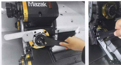
ワンハンドレンチはバネによる保持機構で簡単に固定可能
