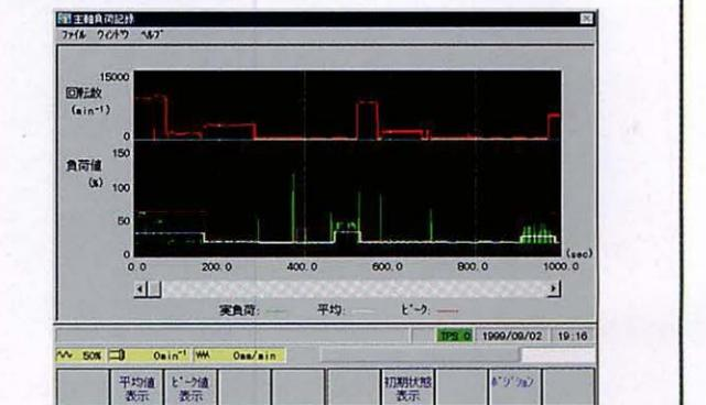
ツール毎の主軸負荷と回転数を加工1サイクル分グラフ表示されますので切削条件の細かな検討ができます。
