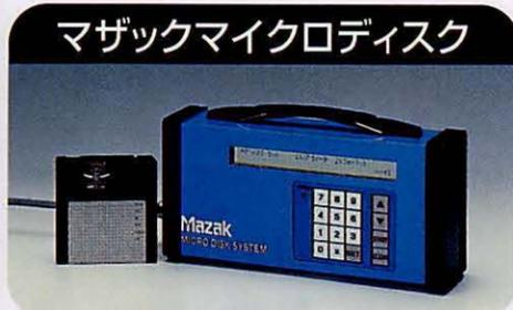
CNC工作機械、自動プログラミング装置、エディタなどとのデータ転送が3.5インチフロッピーディスクにより行えます。
