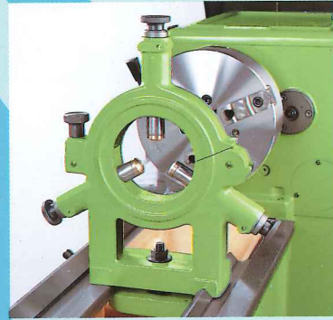
固定振止め ベッドに取付け、長尺加工物を保持し ます。
