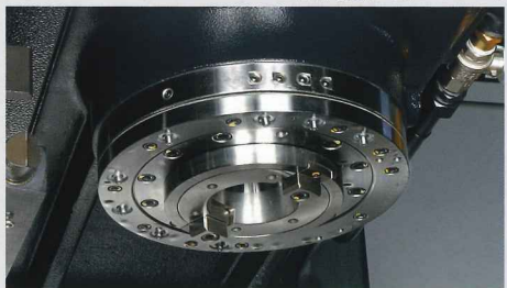
主軸に大径ベアリングを採用。 (VM53R No.50ギヤヘッド・VM76R No.50ギヤヘッド)
