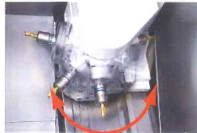
B軸割出角度225° (最小制御角度0.001°)
