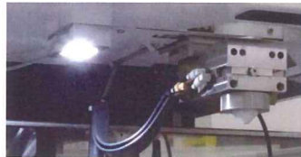
加工槽内用照明灯 (高輝度LED)
