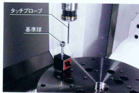
タッチプローブと基準球だけでチューニング完了
