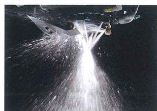
■ エアアシスト式ツール洗浄 (オプション) 高い吐出力により切粉かみを防止。
